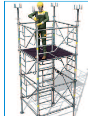
11 - Mise en place et réglage des vérins de tête.
