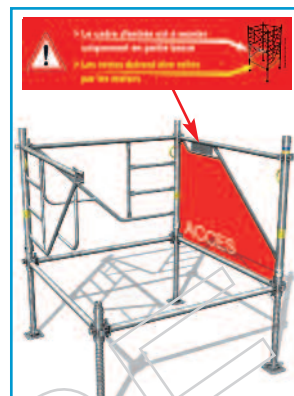
3 - Pose du cadre d'entrée qui facilite l'accès.
