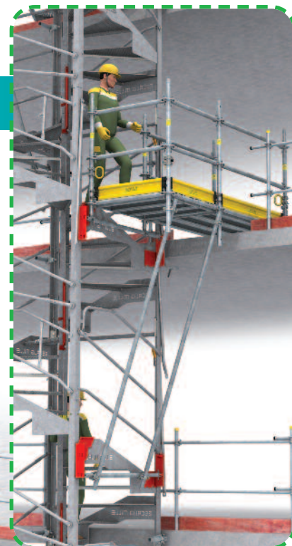
La passerelle en console est soutenue par 2 tubes Ø 49 fixés au niveau inférieur sur une lisse de 1,50 m solidaire de 2 "supports passerelle".
