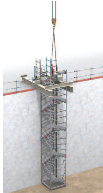
Schéma d'un Escalib Mills MDS suspendu pour accéder au fond de fouille.
