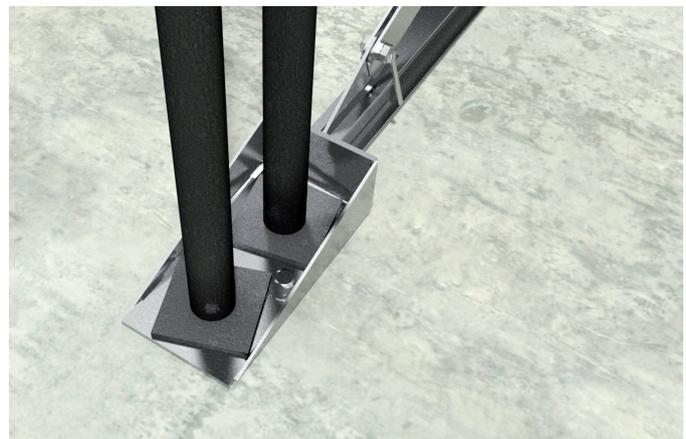
Werden die Tragholmen mit Dywidagananker fixiert, so ist darauf zu achten, dass immer zwei Dywidagverankerungen angebracht werden. Nach dem Motto „eine Schraube ist keine Schraube“.
