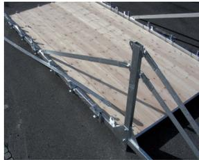
Einstecken der Seiten-schutzgeländer und des Front-Seitenschut-zes.
