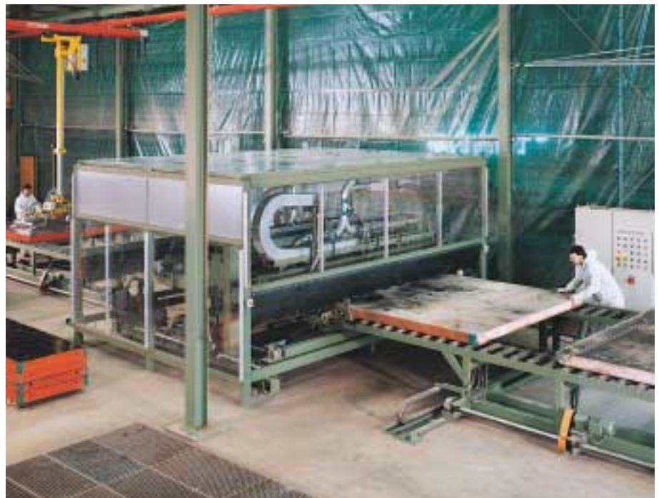
L'installation de nettoyage PERI en cours d'utilisation.
