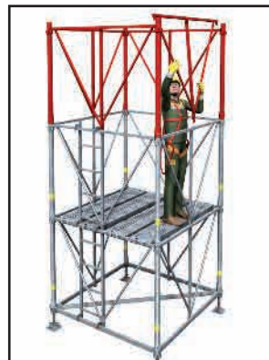
> 6 - Depuis le plancher complet, mise en place des poteaux et des cadres du niveau supérieur.
