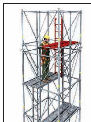
> 10 - Pose de l'échelle à côté de la précédente puis remonter les 2 plançons.
