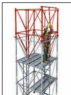
> 9 - Depuis le plancher complet, mise en place de l'étage coulissant et de l'étage courant.
