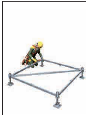
> 1 - Implantation et mise à niveau.
