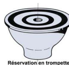
S'il n'est pas possible de retirer la réservation avant le décoffrage de l'élément de béton, on utilise des réservations en acier avec des bagues contentives.
