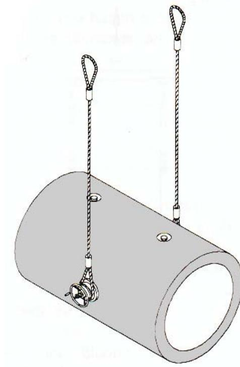
De par sa conception, l'anneau de retournement et de levage est un accessoire destiné au levage en cisaillement qui permet en même temps la rotation des pièces en béton préfabriqué.
