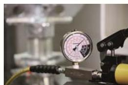
Le vérin hydraulique est constitué d'une pompe à main et d'un cylindre hydraulique. La jauge permet aussi bien de vérifier la pression (bar) que la force (kN)
