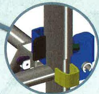
Points de fixation intégrés pour mise en place de plinthe
