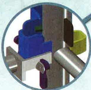
Assemblage automatique des cadres entre eux. Sans outil, un contrôle visuel suffit.
