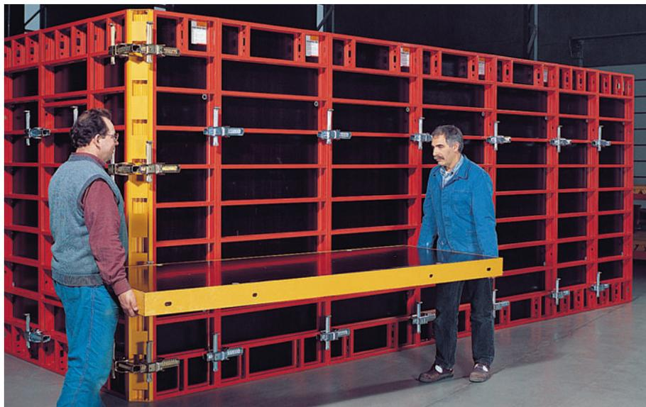
Les éléments DOMINO sont extrêmement légers. L'élément de 250 x 100 en aluminium ne pèse que 59 kg.
