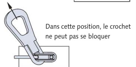
Dans la position de la figure 1 (représentée ci-dessus), l'étrier risque de se coincer dans la tête de l'anneau si l'effort de soulèvement  $F$  est perpendiculaire à l'étrier et de se déformer (figure du haut). Pour éviter ce problème, il suffit de tourner le crochet de  $45^\circ$  environ (figure du bas).
